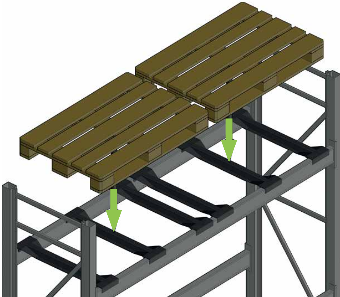
Abb. 11 Paletten quer eingelagert
