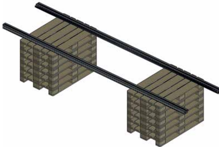
Abb. 45 Ständerprofile zur Ausrichtung der Ständertiefe auf Paletten aufgelegt
