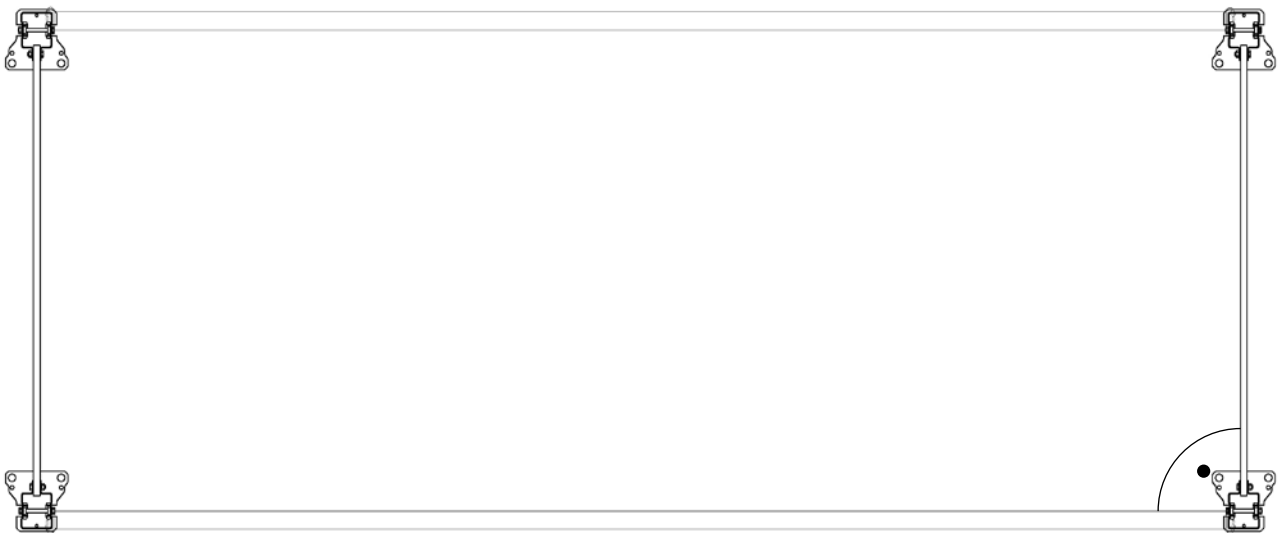
Abb. 76 Rechtwinkligkeit des Regalfeldes
