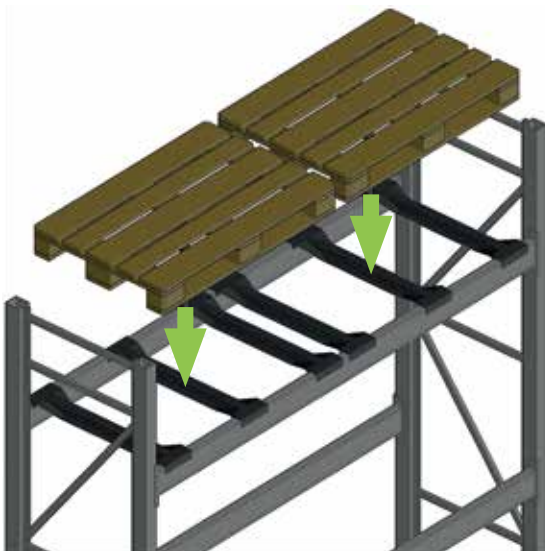
Abb. 32 Tiefenstege zur Einlagerung von Paletten (hier: Paletten quer eingelagert)
