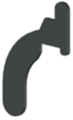
Abb. 20 Aushebesicherung für das CG-System
